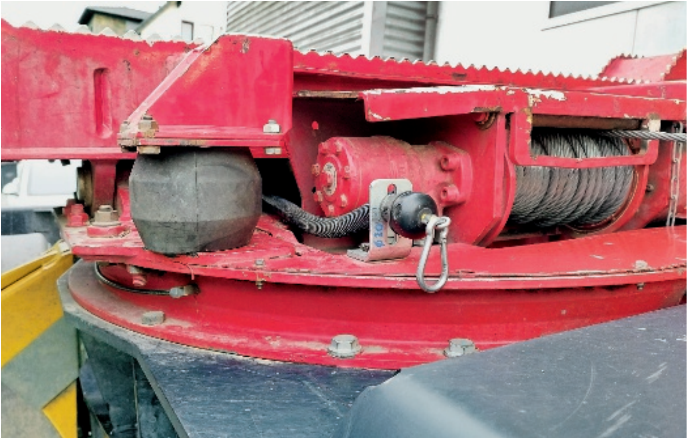
Der Auslass des Leuchtbandes vor dem Schemel des Nachläufers.
